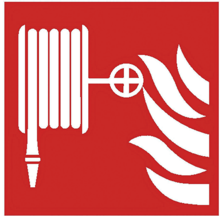
Abb. 16: Brandschutzzeichen F002 „Löschschlauch“ auch Wandhydrant genannt.
