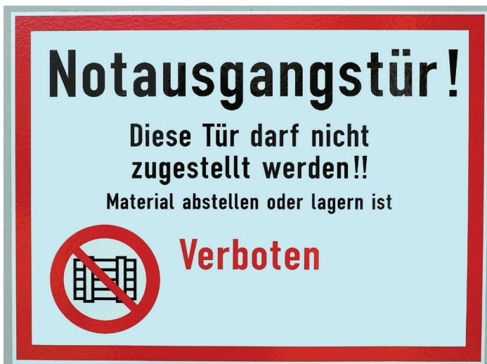
Abb. 7: Hinweisschild aus der Praxis mit dem Verbotssymbol P023 „Abstellen oder Lagern verboten“
