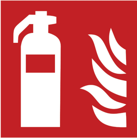
Abb. 15: Brandschutzzeichen F001 „Feuerlöscher“
